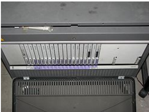
Um PBX Avaya G3si com a frente removida
